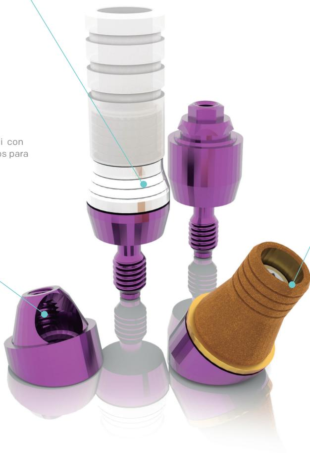
**Fabricados en titanio grado 5, los pilares transepteliales Capitel Mini están diseñados para realizar restauraciones múltiples atornilladas. El sistema dispone de distintas alturas y angulaciones para poder corregir las divergencias entre implantes. Se sirven anodizados para maximizar el mimetismo protésico incluso en biotipos finos, pudiendo individualizar aún más las soluciones protésicas.**
